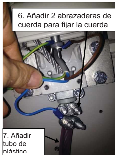
2. Añadir partes metálicas sin apretar!
